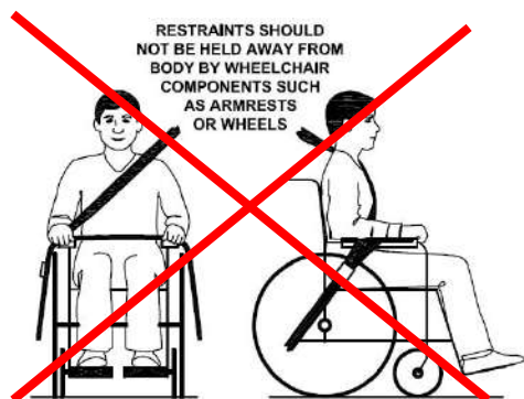
Uso inapropiado cinturón
