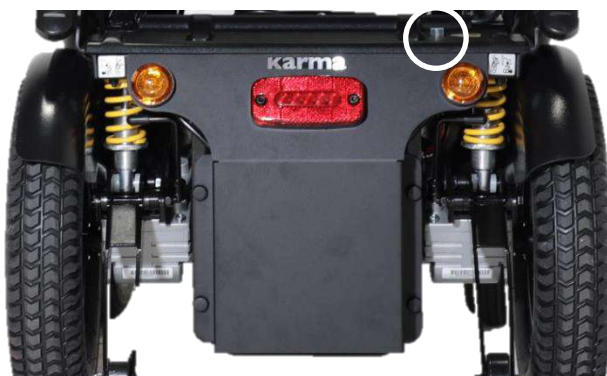
Ubicación interruptor sobrecarga
